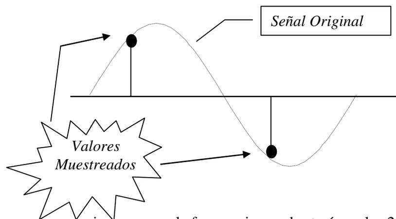
En ella se puede apreciar que si conocemos la frecuencia, nos bastará con los 2 puntos indicados (los muestreados) para “a simple vista” imaginarnos como mínimo una gráfica como la indicada por el trazo punteado. El resto, corresponderá a un filtro pasa bajos que realizara el efecto de “conformación” (reconstrucción) de señal para obtener la señal de origen.
