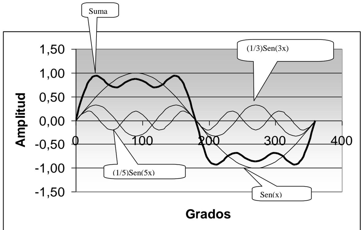
En las figuras anteriores notamos que a medida que se van agregando componentes (dos en el primer caso 2.1.c y tres en el segundo 2.2.d ) la sumatoria de la señal se va pareciendo cada vez más a una onda cuadrada.
