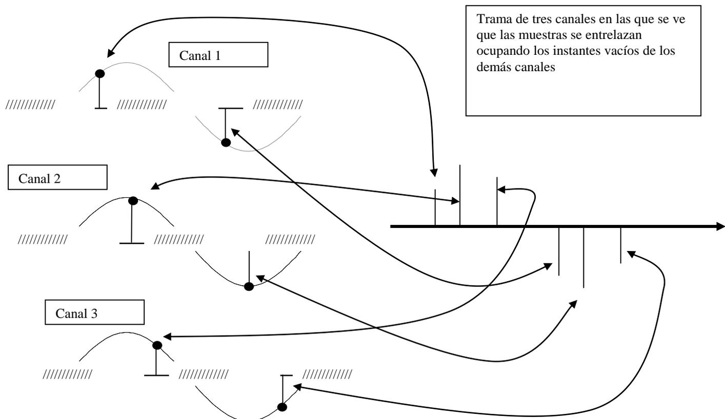
Considerando siempre canales telefónicos, la distancia entre dos muestras será de  $125 \mu\text{S}$  ( $0.125\text{ms}$ ), esto nos lleva a que los datos codificados deberán estar también a  $125 \mu\text{S}$  uno de otro y entre ellos se intercalarán los demás canales como se muestra en la siguiente figura:
