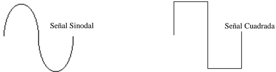
**Amplitud:** es el valor que adopta una variable física en un determinado instante. Se destacan:
