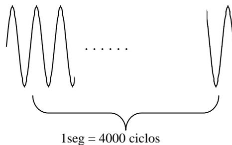
Si codifiquemos la amplitud cada una de las 8000 muestras por segundo con 8 bits, se obtendrá que la cantidad de información a transmitir por el canal es 64000 bps (bit por segundo) o sea la velocidad de un canal telefónico con codificación binaria.
