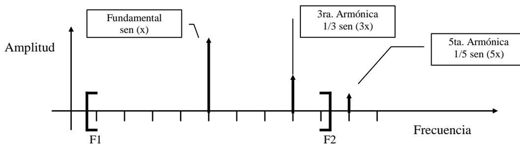
Se ha tomado arbitrariamente valores para de  $F_2$  y  $F_1$  para este canal, de forma tal que se pueda ver claramente como solo es posible transportar la frecuencia fundamental y su 3ra. armónica, sin embargo se comprenderá que no será enviada la 5ta. armónica al quedar fuera del AB; generándose de esta forma una diferencia entre la señal de entrada y la de salida donde aparece una de las clásicas limitaciones tecnológicas que provocan los medios físico en los canales de comunicación.
