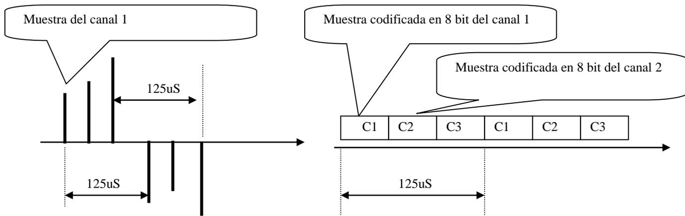
Partamos de las muestras entrelazadas del dibujo anterior (notar que las muestras pueden tener cualquier forma); vemos dibujada a la derecha la trama aplicada a esta comunicación donde cada rectángulo (C1, C2, C3) de la figura es la codificación PCM a 8 BIT de la muestra correspondiente al canal de sonido de una comunicación telefónica.
