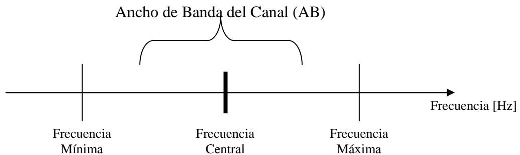
Un punto notable, que se puede apreciar en la figura, es la Frecuencia Media o Mitad, su valor se calcula para un AB como la media aritmética entre la frecuencia máxima y la mínima, o sea:
